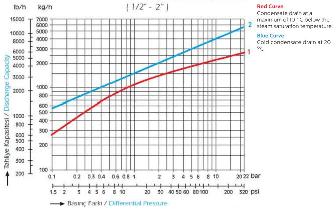
ΔP = Giriş Basıncı / Inlet Pressure - Çıkış Basıncı / Outlet Pressure
